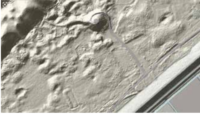
Figuur 12. Het gebied rond de Bloedberg. Delen van de terrein zijn verlaagd ten behoeve van het opwerpen van de Bloedberg (diverse ongeveer rechthoekige terreindelen); zie ook de kruiwagenhelling vanuit het westen naar de top van de Bloedberg. Bewerking van de AHN data (2015) door Dick Bakkenes (2018).
